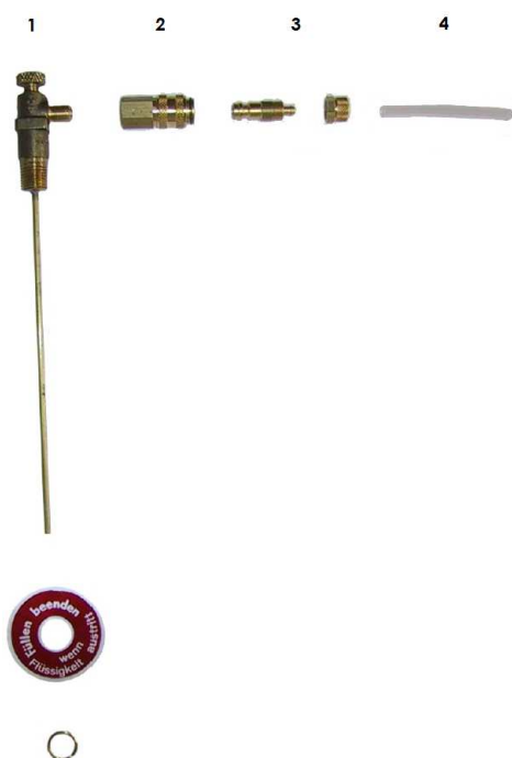
Fig 7-4 : tube de mise à l’air
